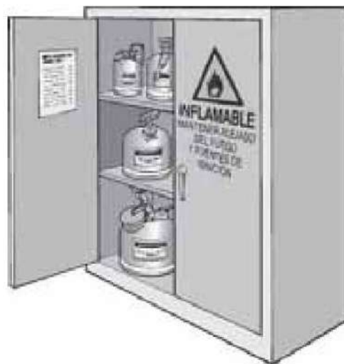
Figura I.15 – Armadio protetto per stoccaggio di prodotti infiammabili
